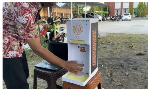
Gambar 4. Pengujian Sensor Ultrasonik dalam Mendeteksi Keberadaan Gelas
